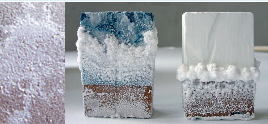
Uitbloeiingen als gevolg van wateroplosbare zouten in bakstenen
